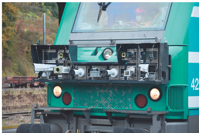
Für die „Labortests im Feld“ wurde eine BB27000 mit Kamera-, Radar-, thermografischen Infrarotsystemen und Lidarsystemen (Lasererkennungssystemen) zur Detektion von Hindernissen und Signalstellungen ausgerüstet.
